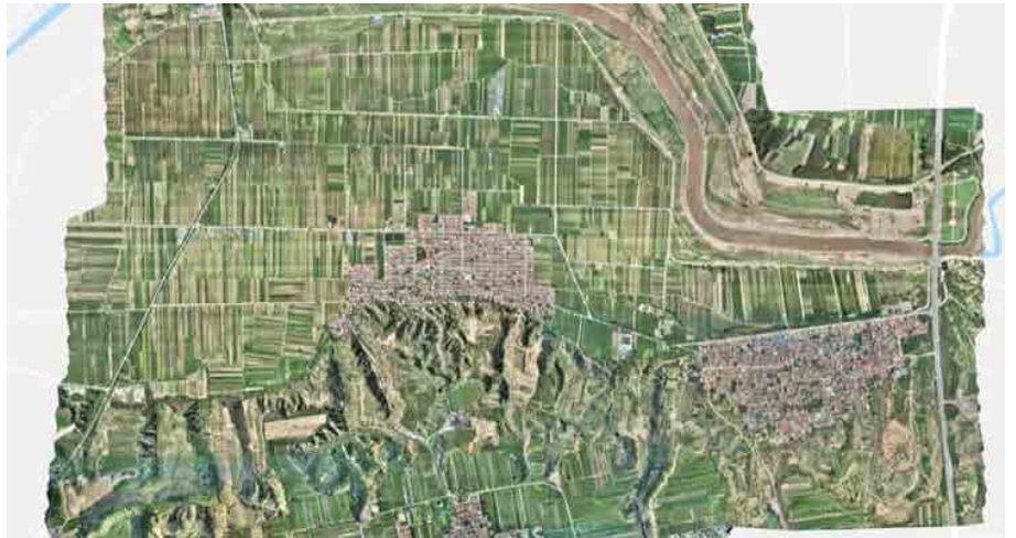
Hình 6: Ghép nhiều dải ảnh hàng không tạo mô hình 3D
